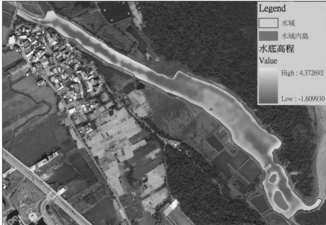
圖 16 網格式的高程量測成果 (10 公尺間隔的測點分佈)
