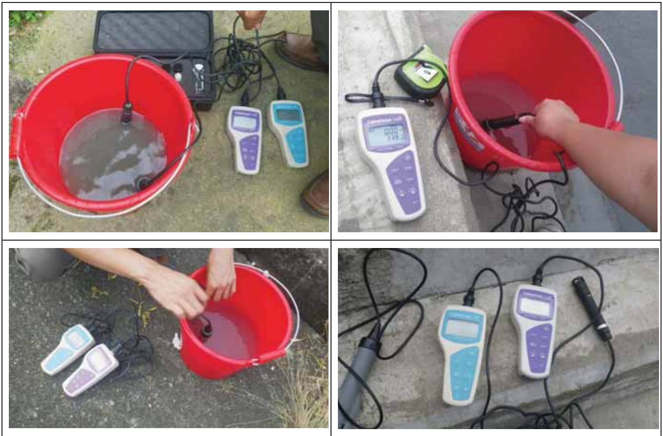
圖 3-15 Cyberscan DO100 攜帶型溶氧量監測儀器
