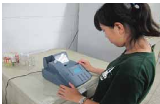
照片 24. 以多功能水質分析儀測定水質 N 及 P 濃度
