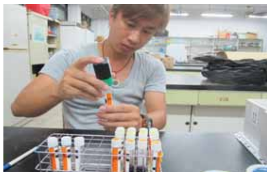
照片 22. 取回水樣加入特定試劑測定 N 及 P 濃度
