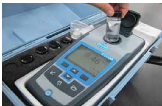
照片 21. 水樣以濁度計測定濁度
