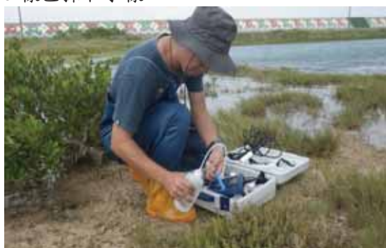
照片 19. 2012 年 9 月漲潮時進行水質測定儀器校正
