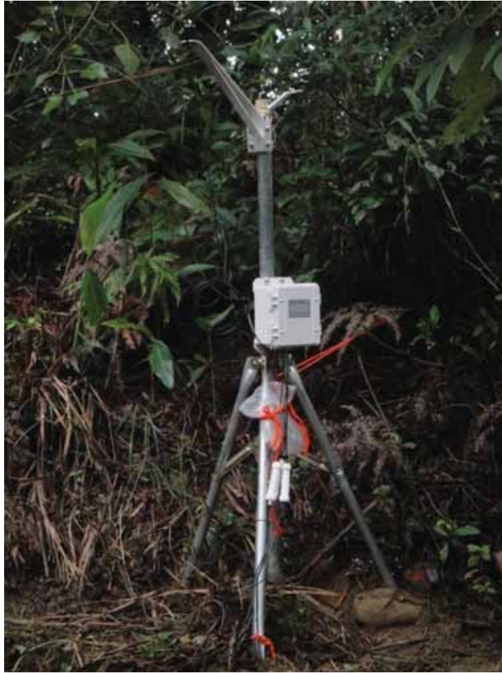
圖 2-8 設置在 Z1 區的微環境監測站
