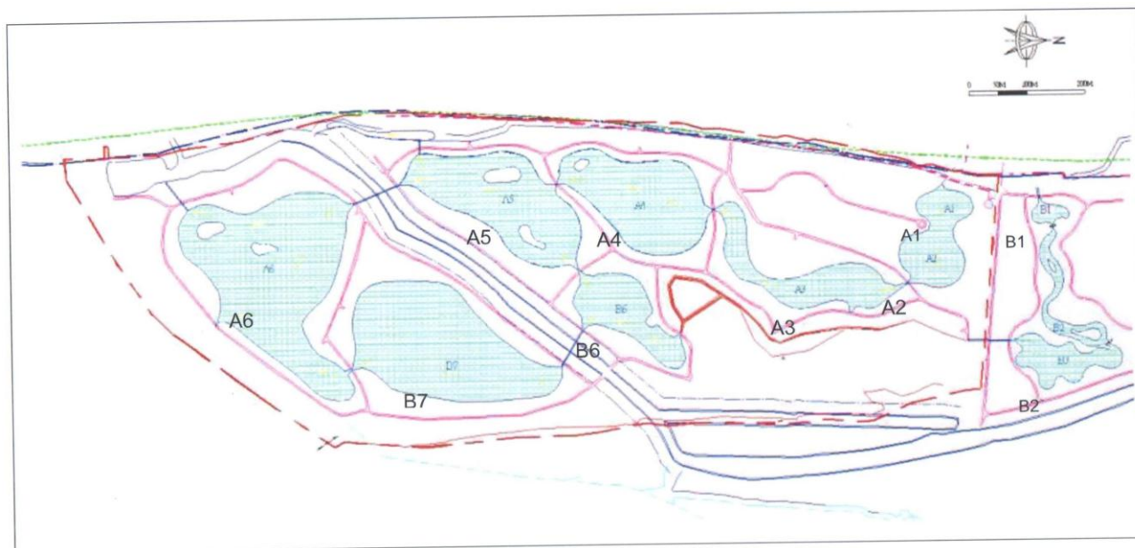
圖 4-8 高屏溪舊鐵橋人工濕地水文流向（八八風災後）
