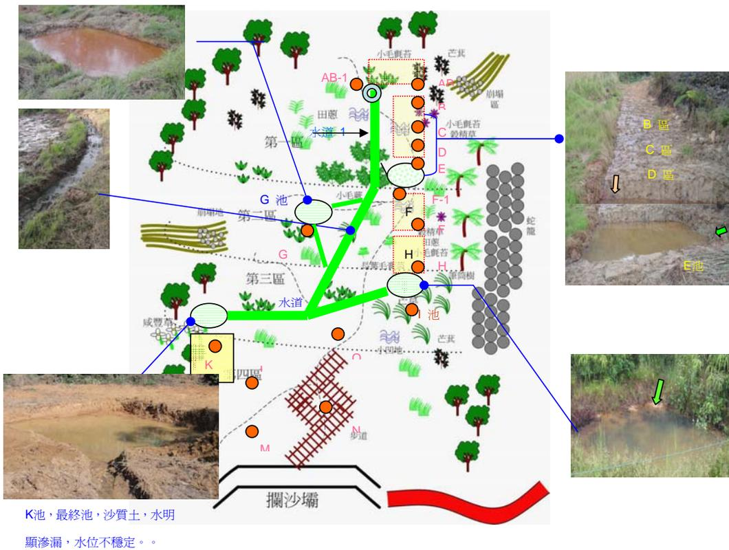
圖 3-16 全區排水示意圖 (箭頭表示水流方向)
