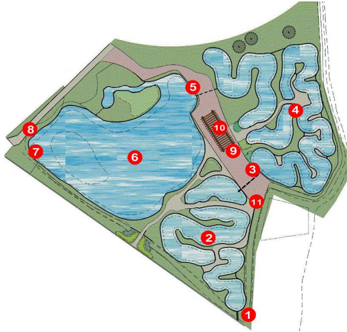
圖 3 本校人工濕地系統的平面圖，1：污水進流口，2：表面下流動(SSF)濕地，3：SSF 濕地出口口，4：表面流動(FWS)濕地，5：FWS 濕地出口口，6：景觀生態池，7：生態池出口口，8：水回收再利用高壓幫浦及管線，9：太陽能光電設施，10：休憩花架，11：氣象及水文監測站，淺紫色區域則為透水鋪面鋪設範圍。
