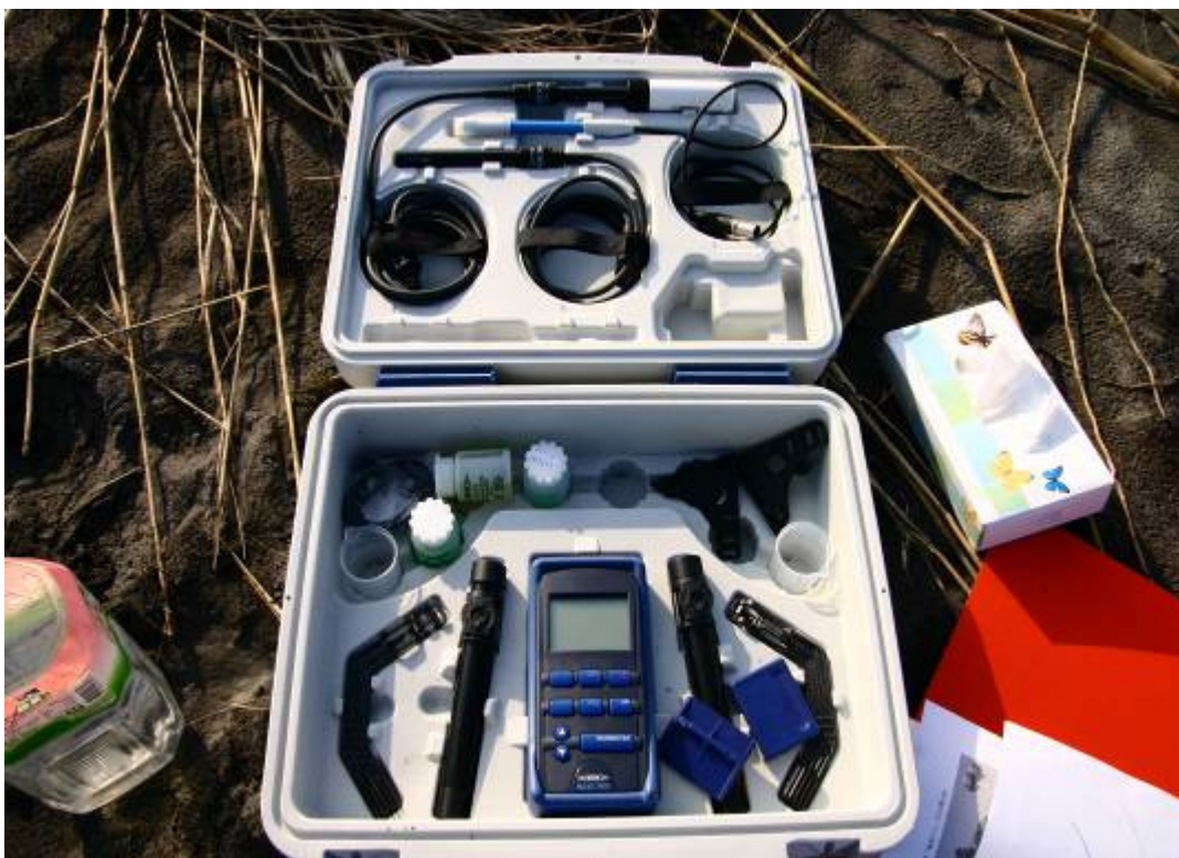
圖 3-13 以 Multi 340i 多功能水質儀檢測
