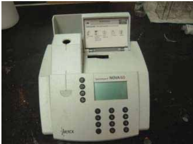
圖 2- 8：水質檢測「水質分析儀」測量儀器圖
