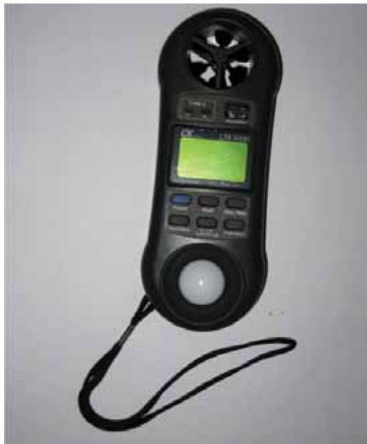
照片 4-1 LM-8000 氣象量測儀
