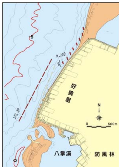
圖 3.30 易淹水地區水患治理計畫-好美寮海岸海岸防護建議佈置方案示意圖 (財團法人成大水利海洋研究發展文教基金會，2008)
