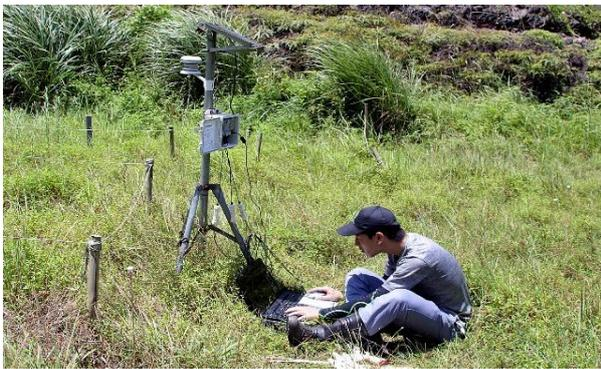
照片 29：HOBO 監測站測量日照光度、土壤濕度、土壤溫度等數據
